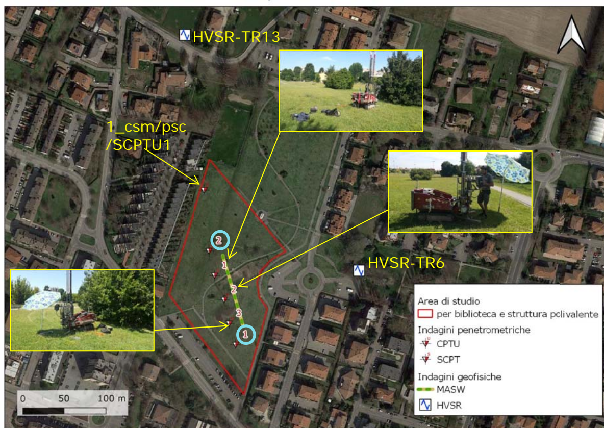
Figura 10 – Ubicazione delle 3 indagini penetrometriche CPTu e dell'indagine geofisica MASW di nuova esecuzione e delle indagini d'archivio: 2 CPTu (cerchiate in azzurro), 1 SCPT e 2 HVSr.
